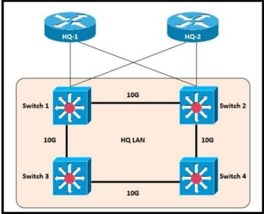
Switch 1 VLAN 110 - 32778 0018.184e.3c00 Switch 2 VLAN 110 - 24586 001a.e3ff.a680 Switch 3
